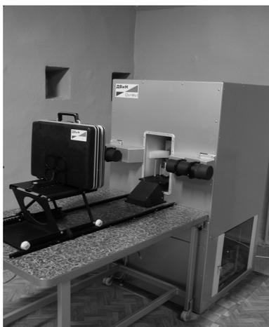
Рис. 1. Установка для идентификации скрытых веществ с помощью метода меченых нейтронов.
