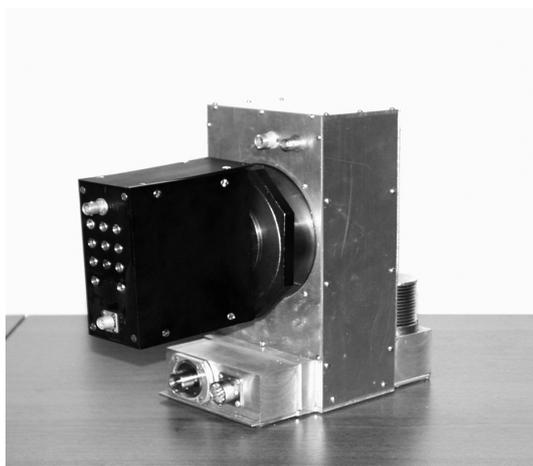
Рис. 2. Портативный нейтронный генератор ИНГ-27.
