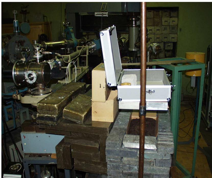
Рис 13. Опыт с ТНТ, экранированным 9 см земли по пучку (ящики слева от чемодана) и 9 см земли на NaI(Tl) детекторе (ящик под чемоданом).
