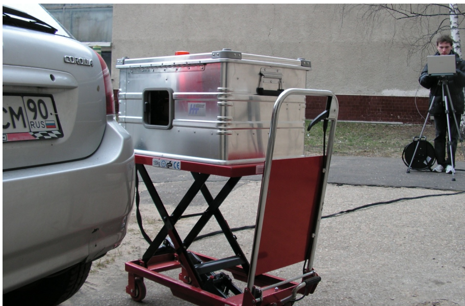
Рис.4 Переносной детектор взрывчатых веществ ДВИН-1.
