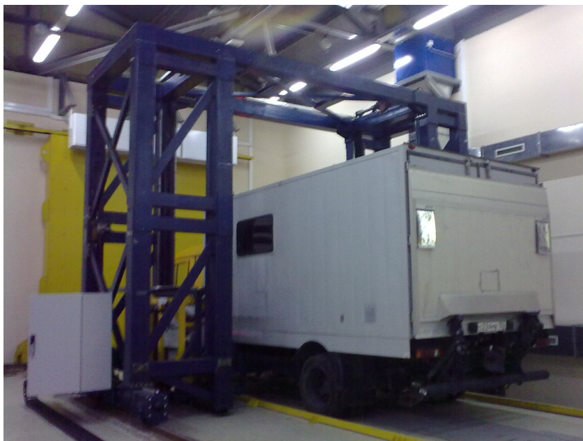
Рис 7. Нейтронный портал для досмотра крупногабаритных транспортных средств.
