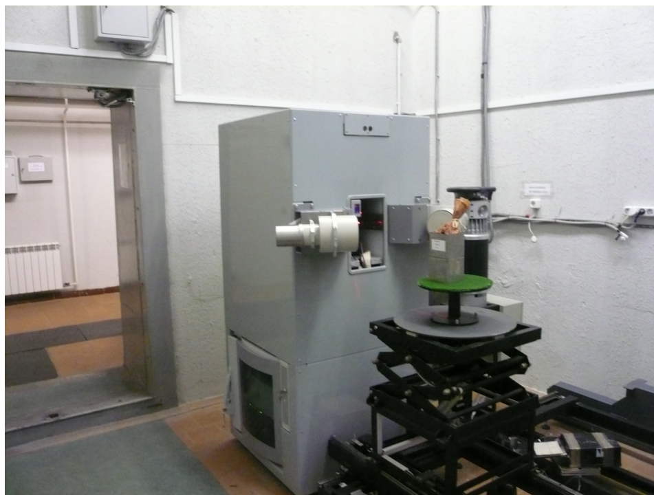
Рис 5. Общий вид стационарной системы для идентификации ВВ.
