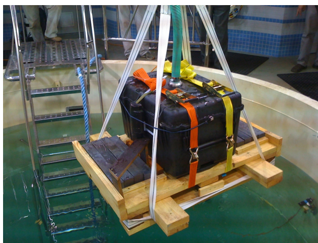
Рис 8. Нейтронный модуль досмотра для работы под водой.
