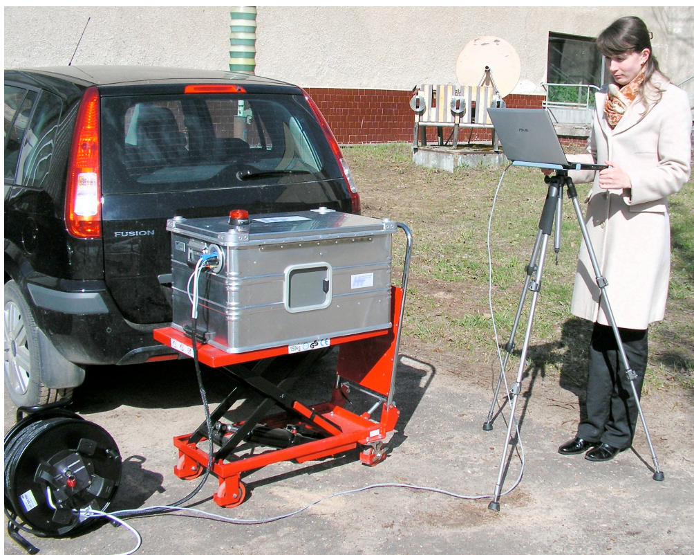
Рис.1 Переносной детектор взрывчатых веществ ДВИН-1.
